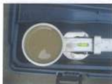
ทดสอบความหนาแน่นของสารละลายพุงหลุมเจาะ
